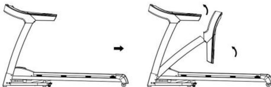
2. С помощью шестигранного ключа 5 мм, винтов M8\*52 и винтов M8\*22 закрепите стойки на корпусе, как показано на рисунке ниже.
