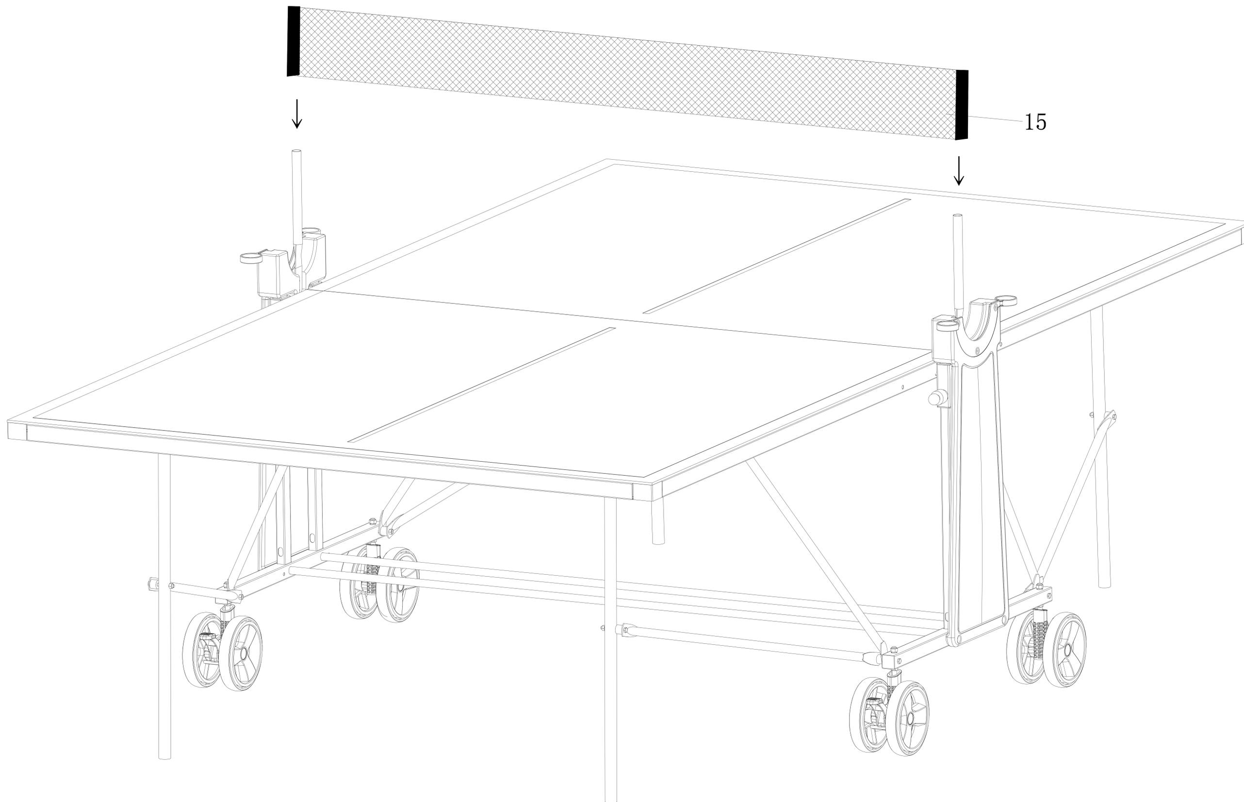
17 Для открытия стола требуется, чтобы два человека, одновременно потянули 16, поворачивая и опуская стол
