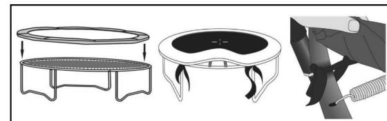
рамы, затем в середине между оставшимися, после чего снова на противоположной стороне. Таким образом обеспечивается равномерное распределение натяжения пружин.
