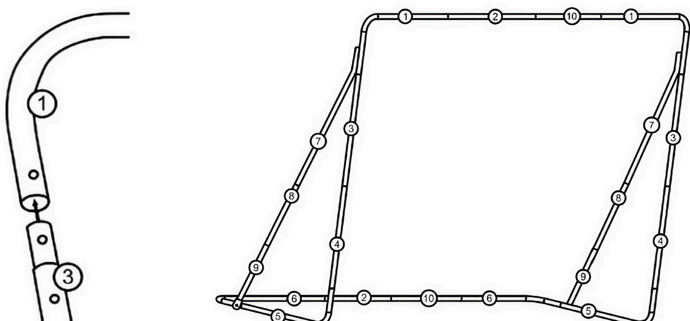
Продолжайте сборку изделия в описанном порядке. При соединении верхней рамы (детали 1 и 2) со средней прямой стойкой (деталь 3), соедините их, как показано на рисунке, оставив место для присоединения детали 4.
