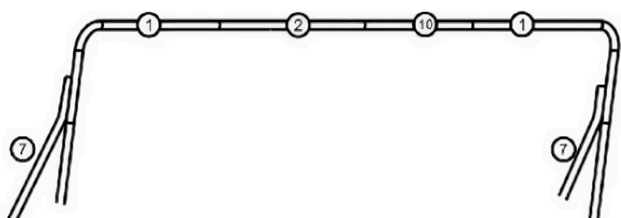
Следуя приведённой ниже нумерованной схеме, соедините части 1–2 вместе, завершив сборку верхней части каркаса.
