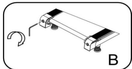
③ Отрегулируйте полотно по прошествии некоторого периода использования. Вытащите предохранитель и переключатель, поверните левый и правый регулировочные болты на 1/4 по часовой стрелке, затем запустите полотно и проверьте его центровку. Продолжайте регулировку до тех пор, пока полотно не будет двигаться строго по центру, см. **РИСУНОК – С.**
